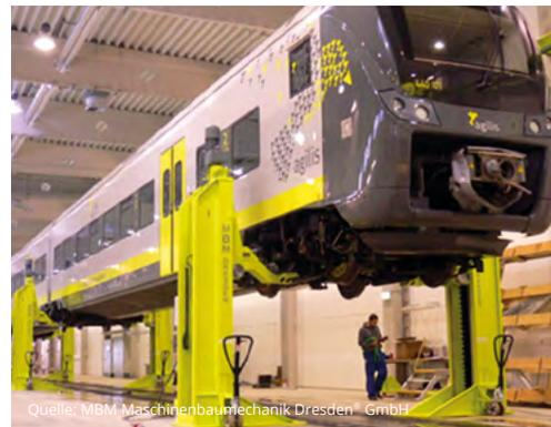
Die MBM Maschinenbaumechanik Dresden<sup>®</sup> GmbH ist auf die Entwicklung, Konstruktion, Fertigung, Montage und anschließendem Service von Transport- und Arbeitsausrüstungen für den Schienenfahrzeugbau / -instandhaltung spezialisiert.
